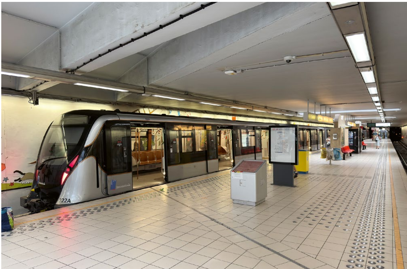
Nejnovější vlak metra řady M7 od španělské firmy CAF ve stanici Stokkel. Tyto jednotky jsou připraveny pro automatický provoz bez strojvedoucího
