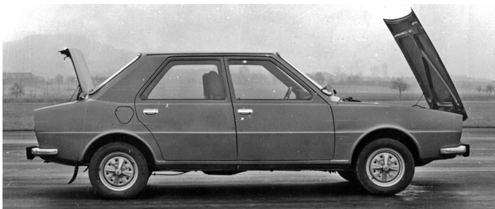
Na rozdíl od Š 727 se přední kapota vozu Š 760 odklápěla kupředu
