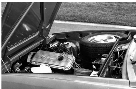
Spolu se čtyřválcem OHC se pod přední kapotu Š 760 vešlo i náhradní kolo
