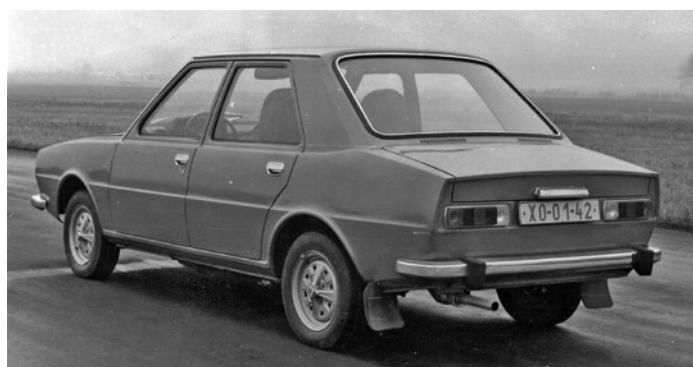
Tam, kde byl původně uložen motor, měla Š 760 zavazadlový prostor
