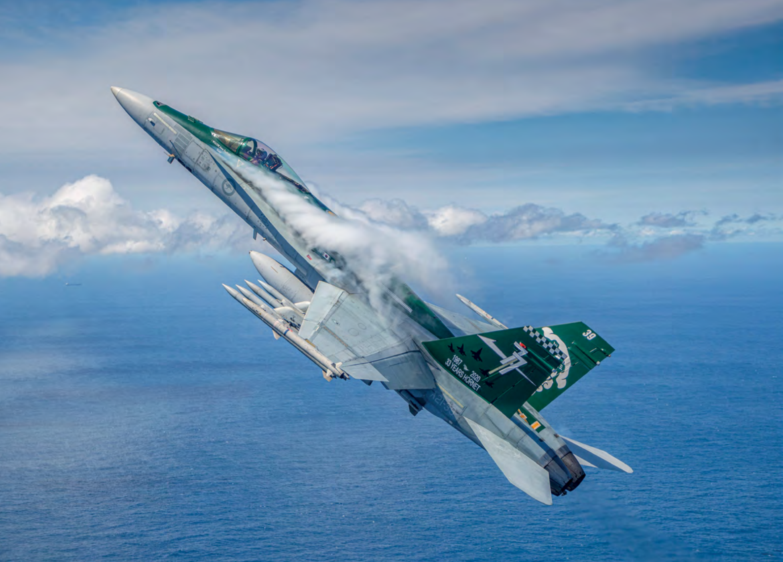
Australský F/A-18A během jednoho z posledních fotoletů před vyřazením. Letoun nese sdružené závěsníky pro střely AIM-120 AMRAAM. Dobře vidět jsou víry generované vírovými přechody.
