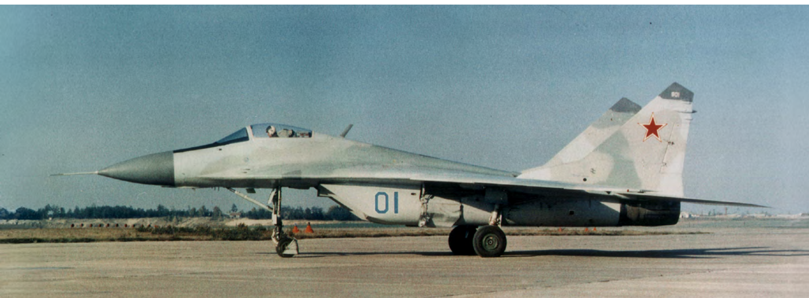
První letový prototyp letounu MiG-29. Stroj nese speciální kamufláž navrženou sovětským výzkumným ústavem letectva pro snížení optické zachytitelnosti.
