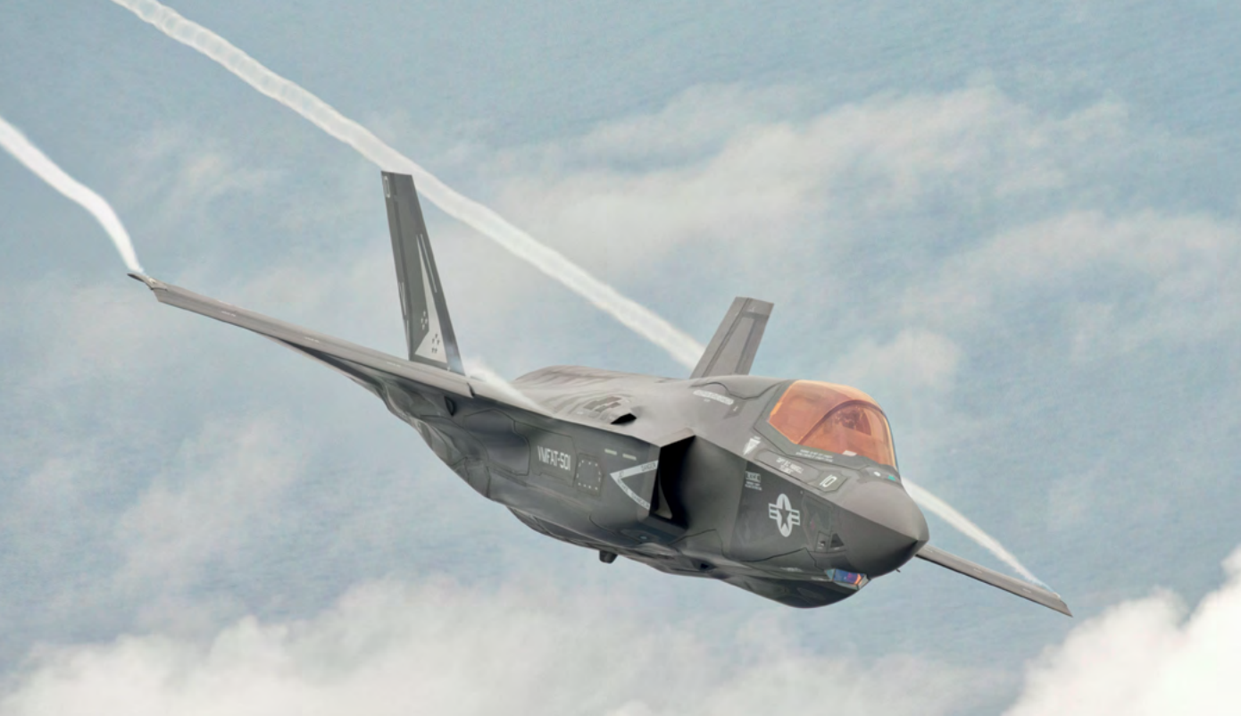
Sériový F-35B americké námořní pěchoty. F-35 je unikátním strojem se třemi způsoby vzletu a přistání – konvenčním, kolmým a palubním.
