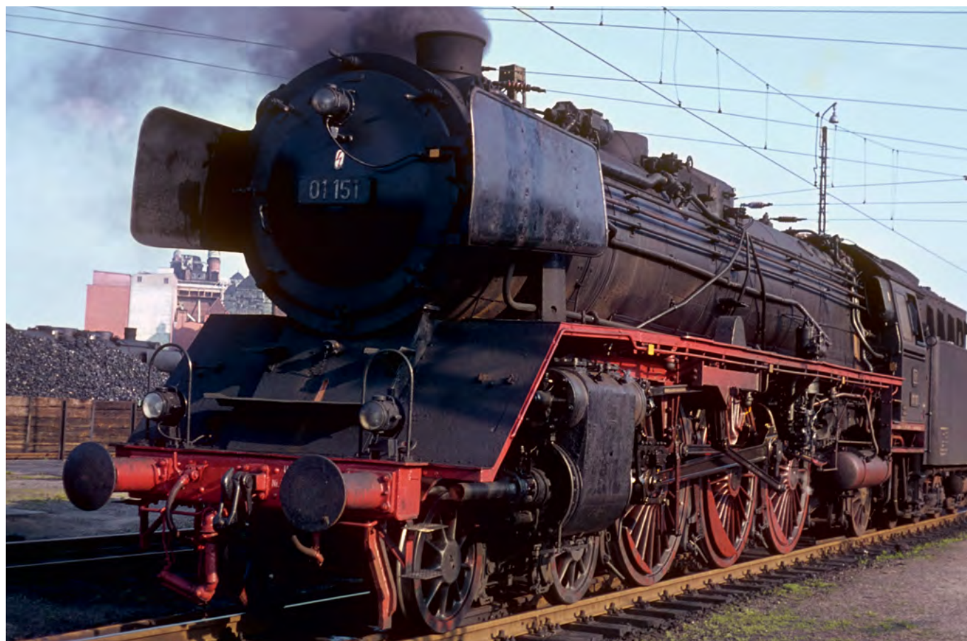
Jednoho srpnového dne roku 1965 byl pořízen v obrátovém depu Bamberg tento snímek lokomotivy 01 151 depa Hof, ještě s původním provozním číslem. Velmi dobře udržovaný stroj, vyrobený v roce 1935 firmou Henschel & Sohn
