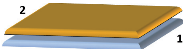
Obrázek 2.2 Vzájemná interakce systému materiál (1) / povrchová úprava (2) / prostředí.
