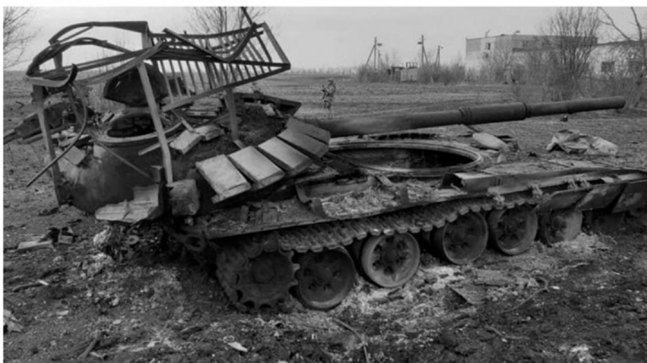
Obr. 1-19: Zničený ukrajinský tank T-64BV (nahore) a ruský tank T-72B3 (dole). Odmrštěné věže v důsledku exploze uvnitř tanku. Automatické nabíjecí zařízení u většiny ruských a ukrajinských tanků má munici uloženou v karuselu pod podlahou (T-72, T-90), nebo na boku věže (T-80, T-84, T-64). Pokud PTRS zasáhne tank shora nebo mezi věž a korbu, může dojít k probití pancíře (tloušťka pancíře stropu věže je 25–50 mm) a vyvolání výbuchu uložené munice, který dokáže věž odhodit. Média často uvádějí, že se jedná o ruské tanky, ale skutečností je, že obě strany přišly o velké množství techniky. (Zdroj: MO Ukrajiny a Ruska)
