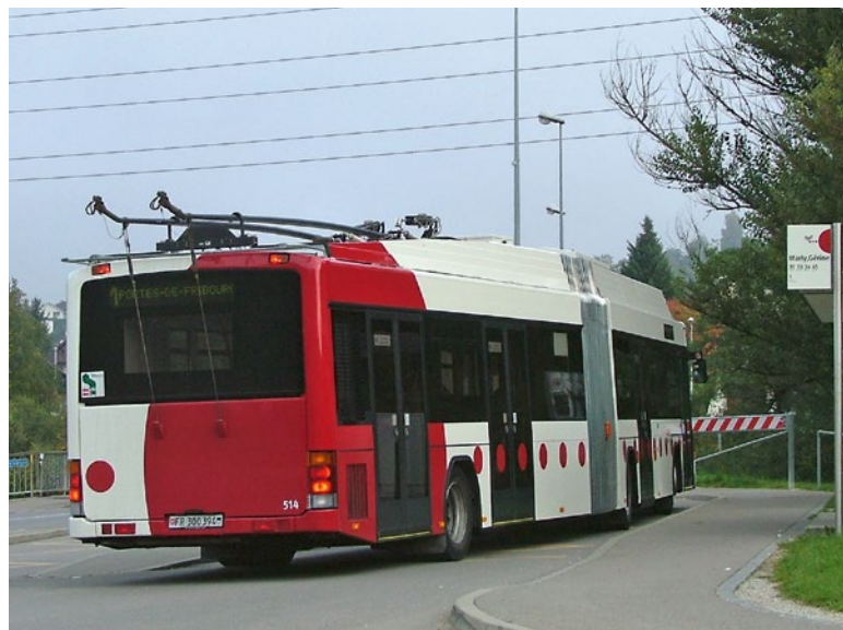
➤ První moderní duobusy byly vybaveny výkonnými pomocnými vznětovými motory, s nimiž mohly zajíždět i na delší nezatrolejované trasy
