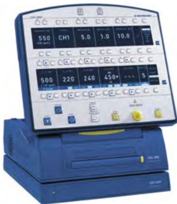
Obr. 1.2 Stimulátor – zdroj elektrických impulzů s celou řadou nastavitelných parametrů
