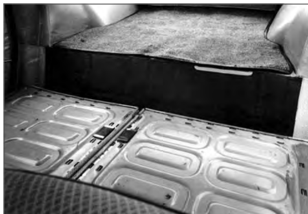
Kryt motoru tvořil schod v podlaze kombi
