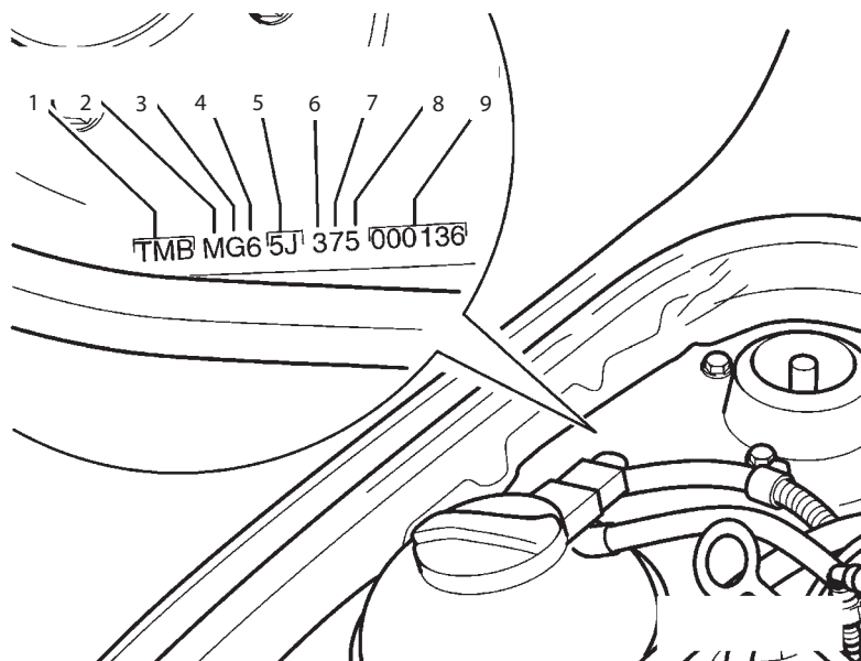
OBR. 2 Identifikační číslo vozidla na pravém uložení tlumičové vzpěry
