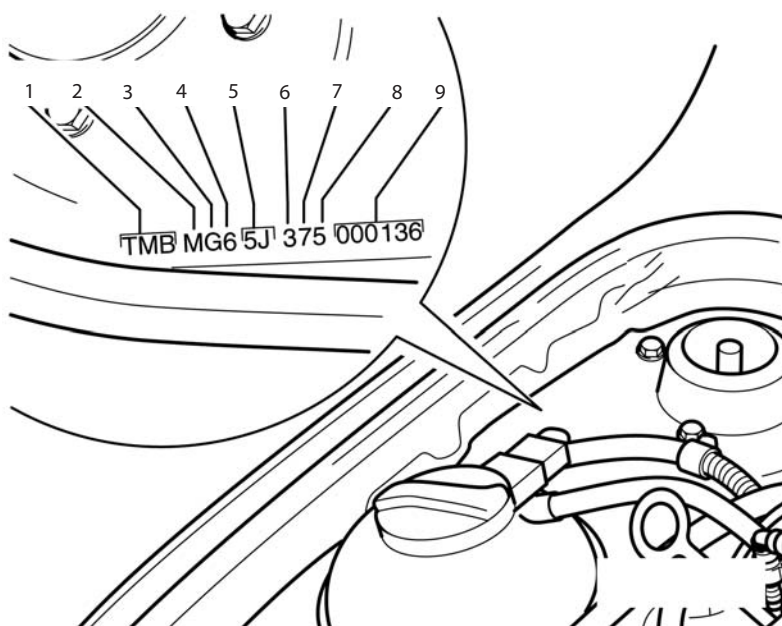
OBR. 2 IDENTIFIKAČNÍ ČÍSLO VOZIDLA NA PRAVÉM ULOŽENÍ TLUMIČOVÉ VZPĚRY
