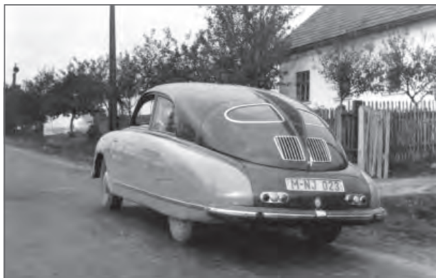
Nově upravená zád' vozu Monte Carlo s motorem V8
