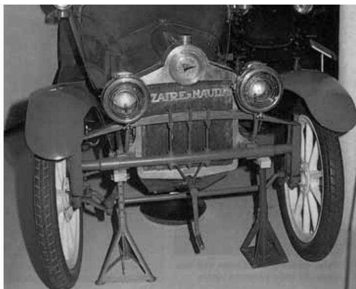
Obr. 1.13 Nezávislé odpružení přední nápravy vozu Sizaire-Naudin
