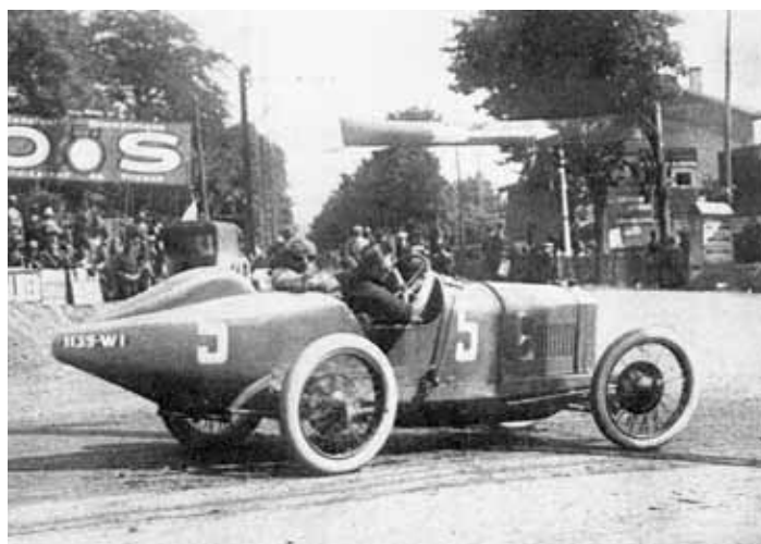
Obr. 2.8 Peugeot 4,5 litru pro GP Francie 1914 s předními brzdami. Motor s rozvodem DOHC s klikovým mechanismem na valivých ložiskách, jezdcem byl George Boillot
