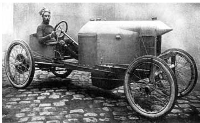
Obr. 2.17 Přední nezávislé odpružení na voiturettě Sizaire-Naudin z roku 1906 s vedením kol v kluzných pouzdech
