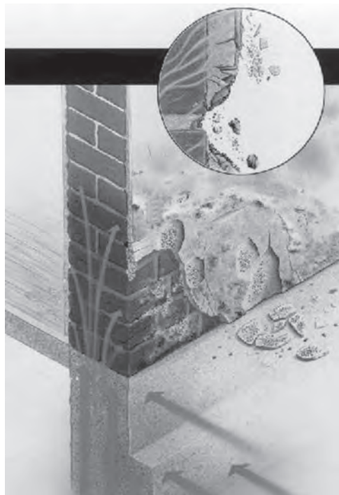
Obr. 1.1 Mechanismus narušení omítky vztlínající zemní vlhkostí (vztlínající vlhkost zavlhčuje omítku, zóna odpařování je na povrchu omítky, krystalizující soli narušují postupně povrch omítky i zdiva)
