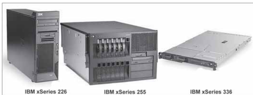
Obr. 2.1 Servery společnosti IBM, první ve skříní obdobné PC, zbylé pro osazení do rámu
