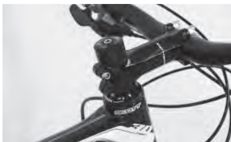
Obr. 8 Nastavení výšky řídítek pomocí podložek na představci
