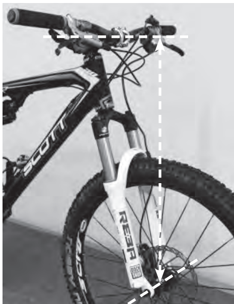
Obr. 7 Vzdálenost osy předního kola a středu řídítek
