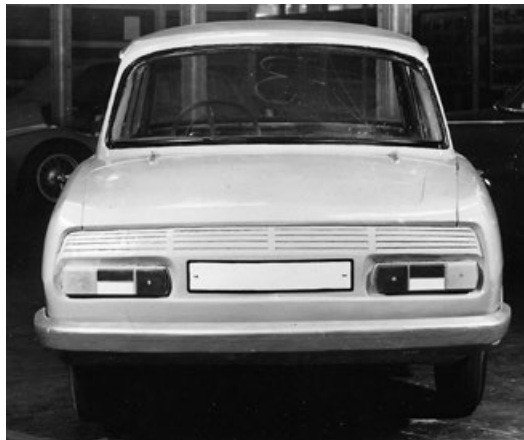
Zád v novém provedení se skupinovými svítilnami dole nad nárazníkem
