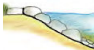
Obr. 2.8 Řešení krajů rybníčku: fólie se položí až nad horní okraj a zatíží se např. kameny. To zabrání tomu, aby se uchýlil porost z okraje
