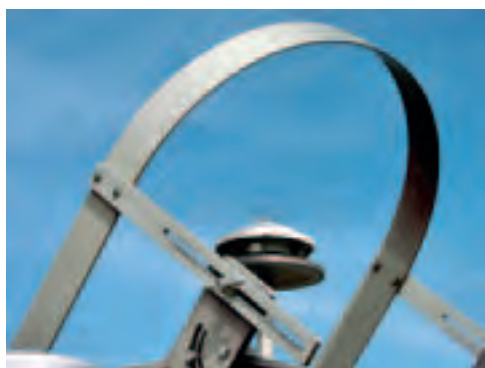
Obr. 1.11 Měření difuzního záření (stínící prstenec)
