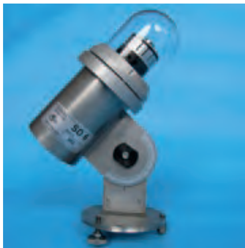
Obr. 1.13 Digitální štěrbinový slunoměr, zdroj: Meteoservis
