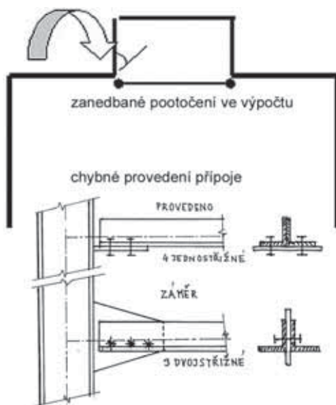
Obr. 2.1 Schéma přípoje havarované haly
