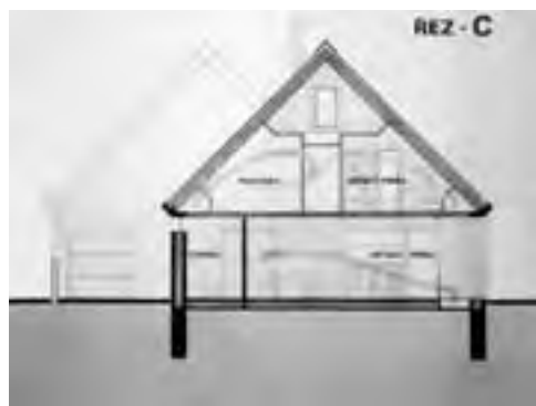
Obr. 6 Řez přístavbovou sekcí se shrnovacím zasklením zimní zahrady na léto
