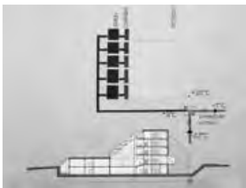
Obr. 2 Schéma proudění řízené výměny vzduchu s rekuperací v zimním období, která nasávala vzduch přes zemní val (administrativní budova OV KSČ, Kolín)
