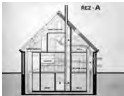
Obr. 5 Řez centrální, základní částí domu, kde byla zimní zahrada a podsklepení s technologickým vybavením kotle na bioplyn a akumulací nádrží na TUV se stratifikací
