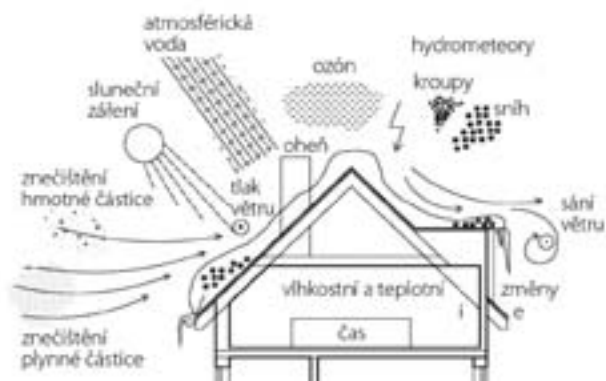
Obr. 1.1 Vlivy působící na střešní konstrukci
