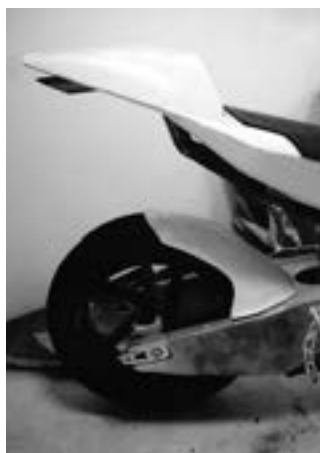
Detail mohutného ramena zadní vidlice
