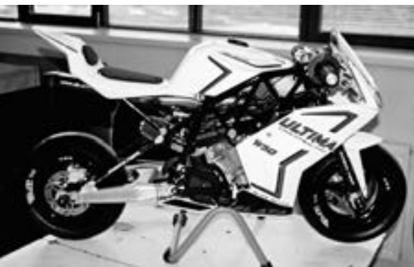
Oboustranný pohled na nejnovější model Ultima W 50 s nastavitelnou charakteristikou podvozku, vlastními kotoučovými brzdami i dalšími komponenty a designem Ing. Hanuše
