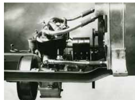
Kapalinou chlazený motor voituretty, jehož válců svírají úhel 55°
