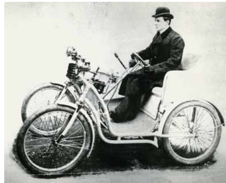
Další křůček ve dvou stopách vznikl spojením dvou motocyklových rámců s pohonem kapalinou chlazeným motorem L&K
