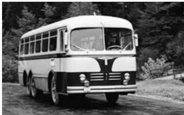
V polovině roku 1954 byly ukončeny oficiální zkoušky prototypu autobusu Tatra T 500 HB s výkyvnými polonápravami a současně s pevnými nápravami. Do sériové výroby šly nakonec autobusy s pevnými nápravami, které byly vyráběny v Karose Vysoké Mýto
