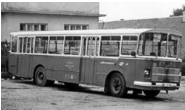
Sériové městské provedení dvoudveřového standardního autobusu Čavdar M80, stavěné na českém podvozku Škoda RTOch, detailně ukazuje záběr ze srpna 1971
