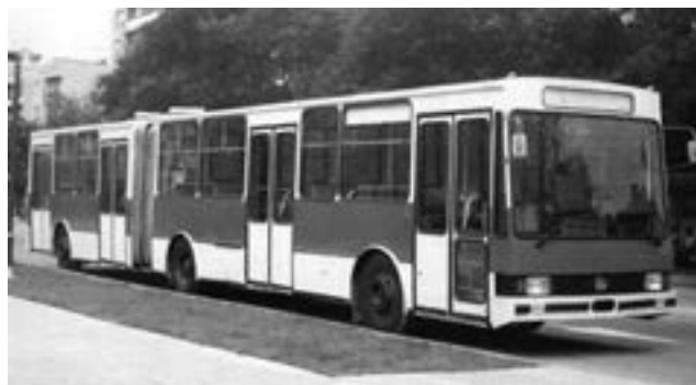
Článkový Čavdar B 14-20 z roku 1982 měl stejnou motorovou skupinou jako standardní typ B 13-20. Autobus o délce 16 780 mm nabízel 38 míst k sezení a 109 k stání, byl v provozu ve všech větších bulharských městech
