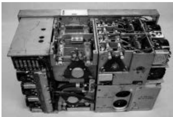
Pohled na vnitřní konstrukci německého superhetu
