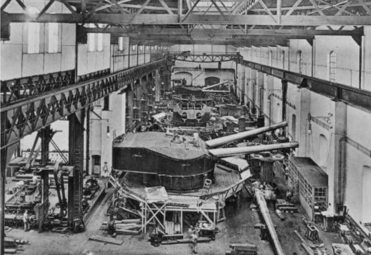
Velká montovna Škodových závodů s dělovými věžemi pro ráži 24 a 30,5 cm
