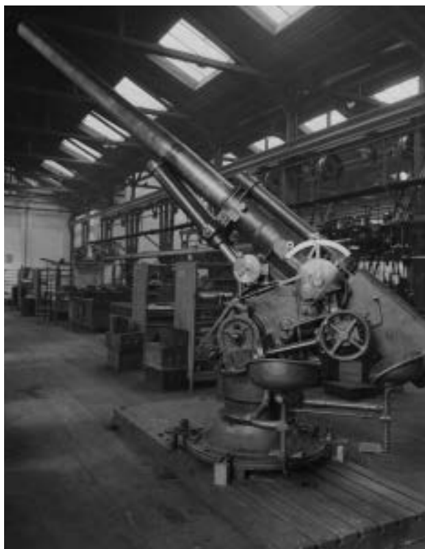
Lodní protiletadlový kanon 9 cm M.12 vyrobený již po válce jako vzor 12/20
