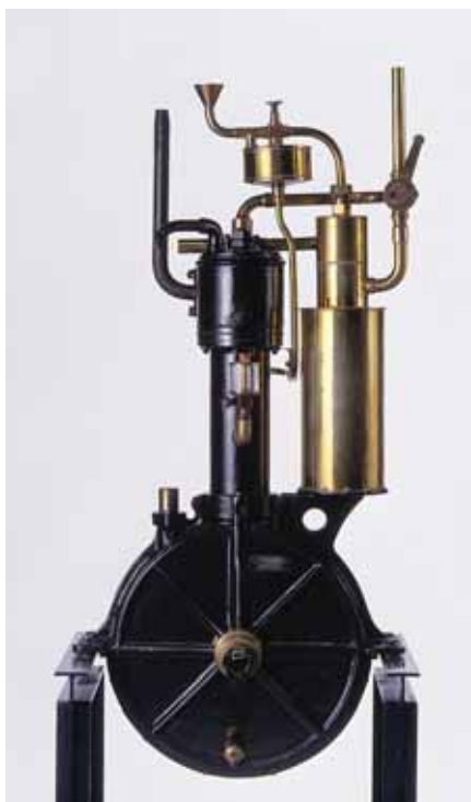
„Stojací hodiny“ (1884): Čtyřdobý benzinový jednoválec Daimler, 264 cm 3 / 1 k, 60 kg
