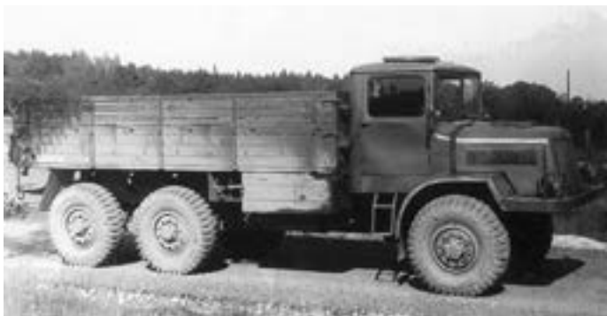
▼ Tatra 130, prototyp pětitunového nákladního terénního automobilu 6×6
