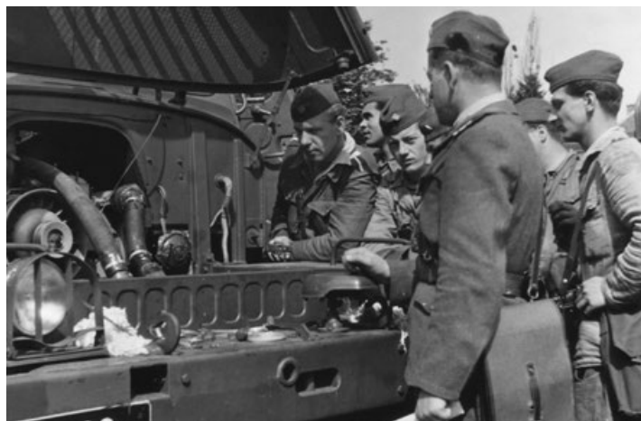
Školení řidičů 1. autopraporu před hlubokým broděním, na snímku je vidět některé úpravy: sundaný čistič vzduchu a místo něho připevnená hadice na přívod vzduchu, sejmuté klínové řemeny k ventilátoru
