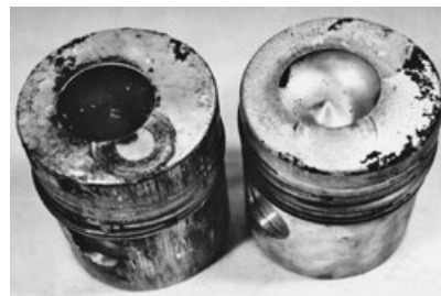
Poškození čelní plochy pístů motoru od hlav ventilů. Jedná se o zkušební písty se dvěma stěracími kroužky, které byly zamontovány v motoru číslo 100046 [1]
