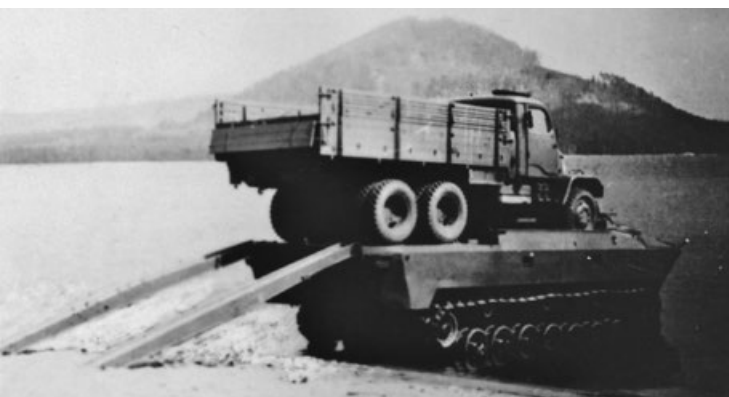
Záběry ze zkoušek s VOŽ (velký obojživelník ženijní) s továrním označením Tatra 807: ten ve zkouškách neuspěl, místo něho byl zaveden sovětský PTS [1]
