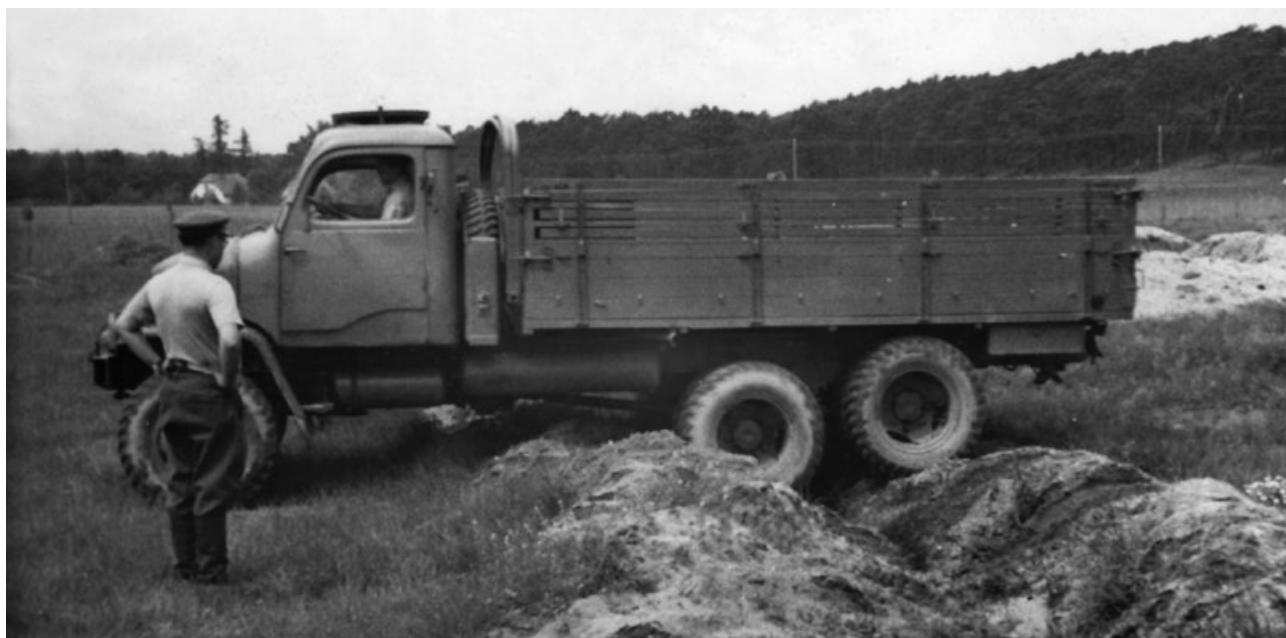
V3S/III při jízdě v písčitém terénu, pod kabinou menší pohotovostní vzduchojem (o obsahu 40 l), za ním pod korbou větší zásobní (80 litrový) vzduchojem [1]
