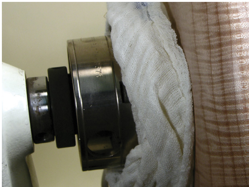
1.16 Leštící hadr, vytržený z ruky, se omotal kolem obrobku.
