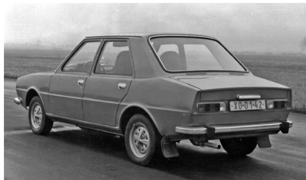
V zádi karoserie Š 760 se místo motoru skrýval prostor pro zavazadla
