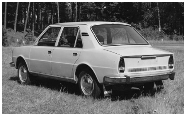
Na zadních sloupcích druhého prototypu Š 742 nově přibily mřížky větrání
