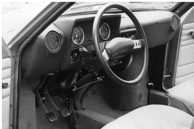
Palubní deska funkčního vzorku Š 727 měla ještě provizorní uspořádání
