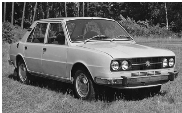
Druhý prototyp Š 742 s rovnou horní hranou masky a spoilerem pod příděl
