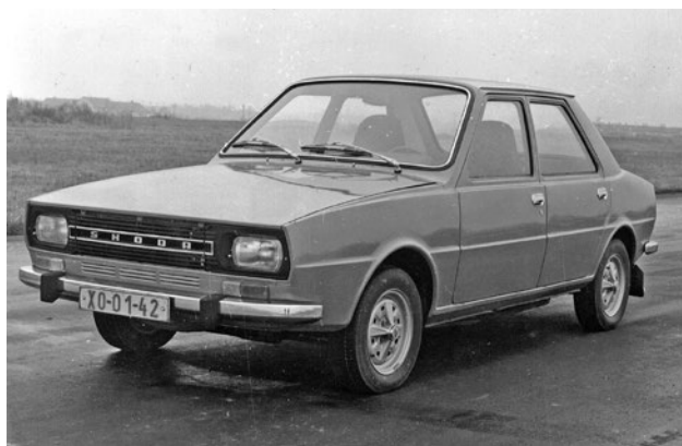
Š 760 s předním pohonem a upravenou karoserií Š 727 z prosince 1972
