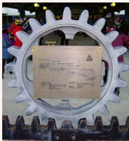
Pátý ozubnicový systém Von Roll
