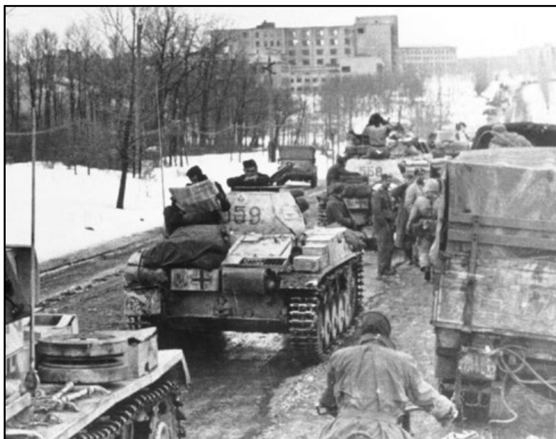
▲ Druhým tankem v této koloně SS-Panzer Grenadier Division „Leibstandarte Adolf Hitler“, která se v březnu 1943 zastavila na předměstí Charkova na Ukrajině, je Panzerkampfwagen II Ausf F se zimním maskováním z vápenného roztoku. Na pancéřovém pouzdře regálu na dýmovnice jsou divizní znaky a Balkenkreuz, napravo od něj je tlumič výfuku a jeho perforovaný štít. Bundesarchiv
