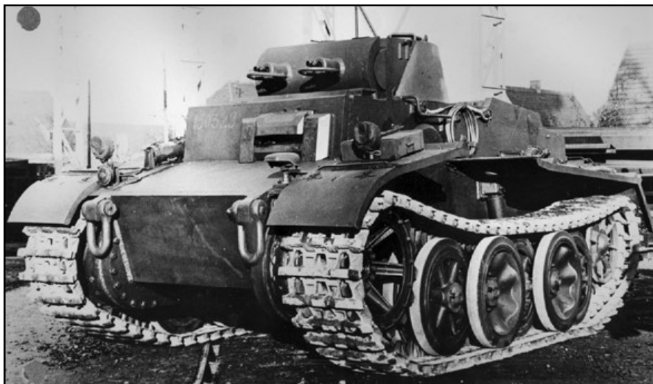
▲ Panzerkampfwagen I Ausf F byl tank určený pro podporu pěchoty, který se mohl pochlubit vynikající pancéřovou ochranou, s 80mm pancířem na čelních plochách a 50mm a 25mm pancířem na ostatních místech. Ve věži byly dva kulomety MG 34 ráže 7,92 mm. Podvozek tvořila vzájemně se překrývající pojezdová kola na torzních tyčích. Řidič měl k dispozici masivní pancéřovaný průzor a binokulární periskop. Pohonnou jednotkou byl motor Maybach HL45P. Patton Museum
