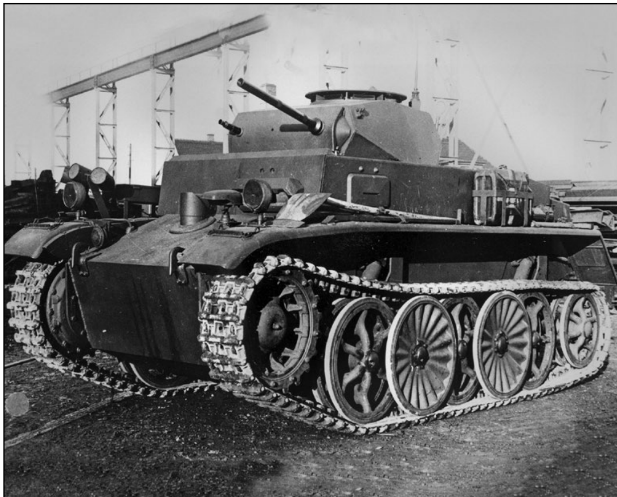
▲ Panzerkampfwagen I Ausf C, kterých Krauss-Maffei sestavil pouze čtyřicet, byl navržen jako lehké vysokorychlostní průzkumné vozidlo. Znamenal naprostý odklon od Ausf A a B, vozidlo mělo korbu a podvozek Krauss-Maffei a rovněž nástavbu a věž konstrukce Daimler-Benz. Věž obsahovala 7,92 mm MG 34 na pravé straně pláště a poloautomatické dělo Mauser EW 141 na levé straně. Na pravé straně byla opatřena kulometem MG 34 ráže 7,92 mm, vlevo byl poloautomatický kulomet Mauser EW 141. Patton Museum
