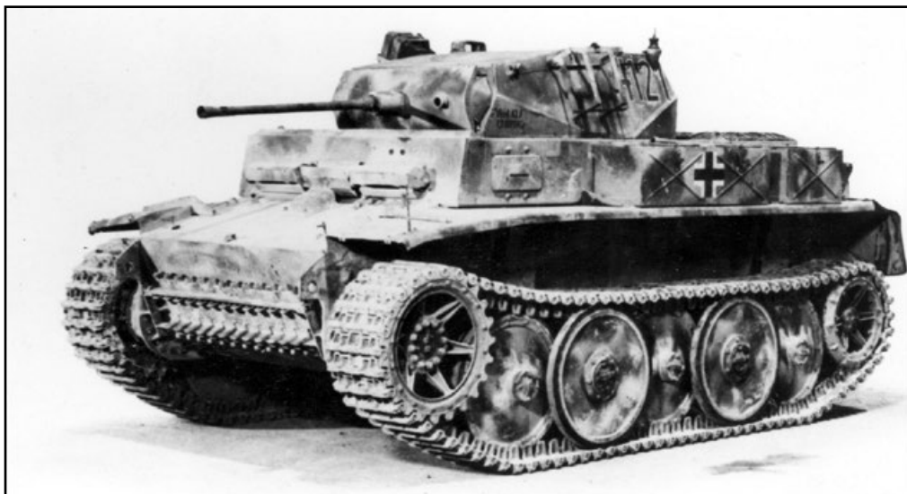
▲ Panzerkampfwagen II Ausf L se obvykle označoval jako „Luchs“ (Rys), ale také jako VK 1303. Byl navržen jako průzkumný tank, měl stejnou spodní korbu jako Panzerkampfwagen II Ausf G, ale s masivními pojezdovými koly a horní část korby byla zvětšená, s cílem vytvořit prostor pro větší prstenec věže. Ve věži byl kanón KwK 38 L/55 ráže 2 cm a kulomet MG 34 ráže 7,92 mm. Na snímku je podvozek číslo 200164 a věž číslo 200143, které ukořistili Britové. Tento tank je umístěn v Tankovém muzeu v Bovingtonu v Anglii. Patton Museum
