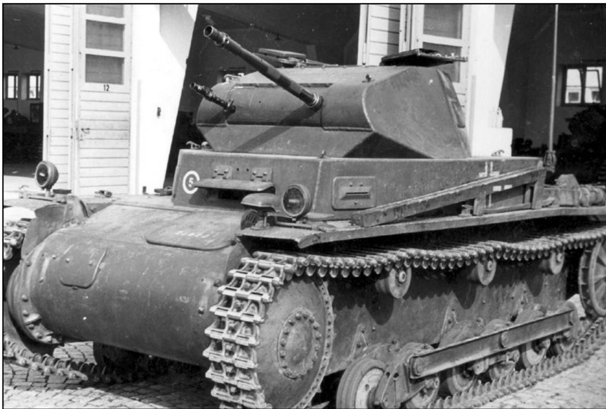
▲ Podvozek Panzerkampfwagen II Ausf b číslo 21022 má na boku levého světlometu zatemňovací světlo Notek: jde o modifikaci, která byla představena v říjnu 1940. Maska kanónu byla konstruována tak, aby se vešla dovnitř, a nikoliv před věž. Přední část korby měla jiné provedení než Ausf a, aby rozměrově odpovídala novému systému řízení. Korba a motorový prostor byly poněkud delší než u Ausf a. Patton Museum
