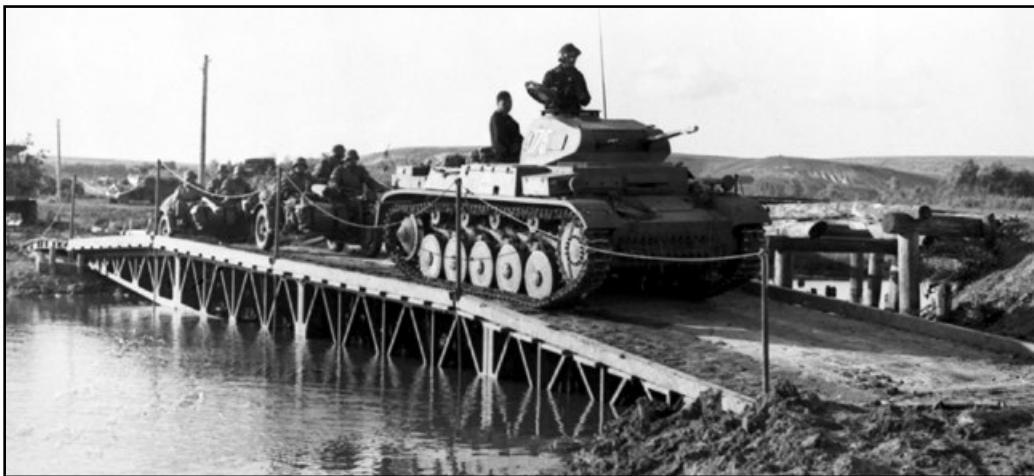
▲ Panzerkampfwagen II Ausf F měl několik nových vylepšení, včetně přídě vyrobené z plochých pancéřových plátů; byl to čelní pancíř nástavby o tloušťce 30 mm, falešný průzor na pravé straně a velitelská věžička s periskopy. Firma Ursus z Polska od března 1941 do července 1942 vyrobila 389 vozidel Ausf F, zatímco firma FAMO dokončila od srpna 1941 do června 1943 120 kusů tohoto modelu, celkem tedy vzniklo 509 kusů. Na snímku je Panzerkampfwagen II Ausf F při přejezdu mostu v Sovětském svazu v červnu 1942. Bundesarchiv
