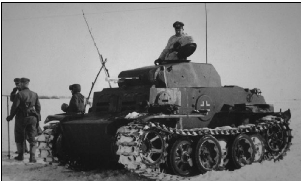
▲ Panzerkampfwagen II Ausf J, kterých firma MAN vyrobila třicet, byl navržen jako těžce pancéřovaný průzkumný tank. Na přední straně byl chráněn pancéřovým plátem tloušťky 80 mm, na bocích a vzadu pancířem tloušťky 50 mm. Blatníky měly po obou stranách tanku mezery kvůli kulatému přiklopů v korbě. Řidič a radista po jeho pravici měli silně pancéřované průzory a pro boční vidění kulatý štít s průzorem. Výzbroj tvořil kanón KwK 38 L/55 ráže 2 cm a kulomet MG 42 ráže 7,92 mm. Patton Museum
