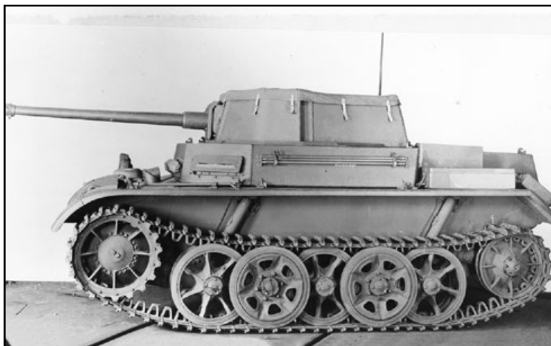
▲ Na snímku je jeden ze dvou zkušebních lehkých stíhačů tanků Panzer Selbstfahrlafette (obrněný samohybný kanón), vyrobených v roce 1941 na podvozku Panzerkampfwagen II Ausf G. Vozidlo bylo v nástavbě s otevřenou střechou vyzbrojeno protitankovým kanónem PaK 38 ráže 50 mm. Tato vozidla měla mít čtyřčlennou osádku. Přední pancíř měl tloušťku 30 mm, boční pak 20 mm. Tento projekt nikdy nepokročil do fáze výroby a oba prototypy byly v srpnu 1942 nasazeny na východní frontě. Patton Museum
