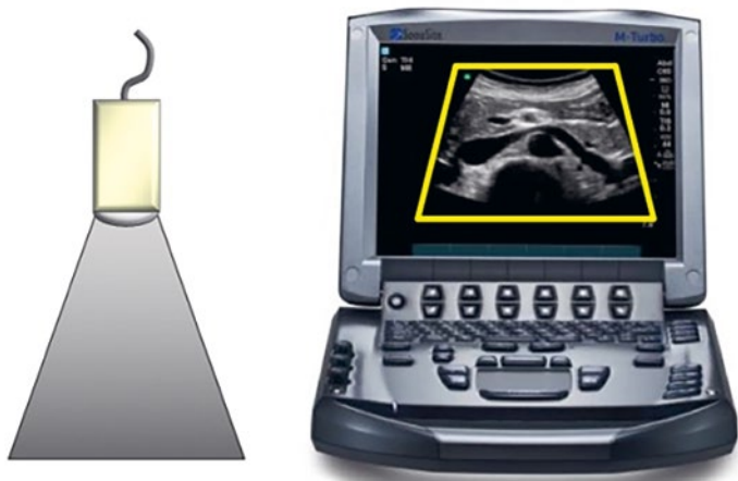
Obr. 1.8 Sektorový formát zobrazení – ultrazvukový signál je vyslán a zpracován v trojúhelníkovém zobrazení
