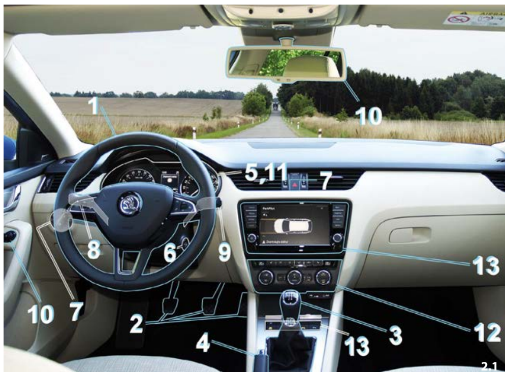
1 – volant, 2 – pedály, 3 – řadící páka, 4 – parkovací brzda, 5 – přístrojová deska, 6 – spínací skříňka, 7 – spínače osvětlení, 8 – kombinovaná ovládací páčka, 9 – ovladač stěračů, 10 – ovladač vnějších zpětných zrcátek, 11 – informační systém, 12 – systém úpravy vzduchu, 13 – další výbava
