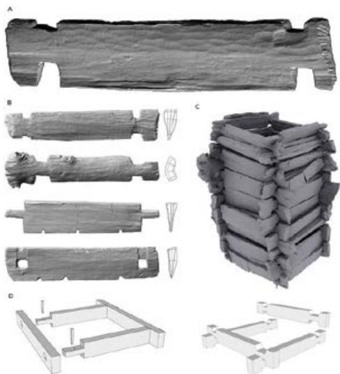
Obr. 13 Digitální model neolitické studny z lokality Eythra u Lipska ukazuje její důmyslnou stavbu, která náleží k nejstarším roubeným konstrukcím na světě. Převzato z: © http://www.archaeo3d.com/
