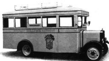
WALTER-PN 40 HP, autobus s podel- nými lavicemi, pro 24 osob, 4-válec, nosnost 2.5 t
