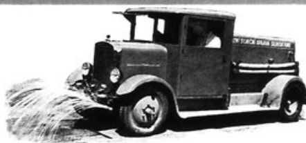
WALTER-PN 40 HP, kropící vůz kombinovaný se stříkačkou, obsah nádrže 2200 l, 4-válec, nosnost 2.5 t
