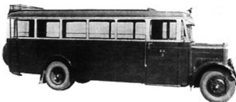
WALTER-FNA 60 HP, autocar Sun- saloon s příčnými sedadly a otvírací střechou, pro 28 osob, 4-válec, nosnost 4.2 t
