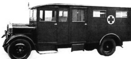
WALTER-PN 36 HP, 4-lůžkový sanitní vůz s kabinou pro lékaře, 4-válec
