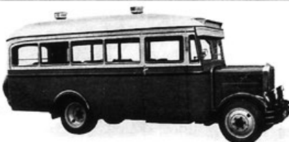
WALTER- UNIVERSAL 60 HP, autobus de lux s příčnými seda- dly, pro 22 osob, 6-válec, nosnost 2.5 t
