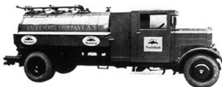
WALTER-FNA 60 HP, vůz s tankem na benzin, obsah tanku 3500 l 4-válec, nosnost 4.2 t
