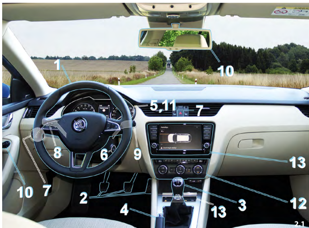
1 – volant, 2 – pedály, 3 – řadicí páka, 4 – parkovací brzda, 5 – přístrojová deska, 6 – spínací skříňka, 7 – spínače osvětlení, 8 – kombinovaná ovládací páčka, 9 – ovladač stěračů, 10 – ovladač vnějších zpětných zrcátek, 11 – informační systém, 12 – systém úpravy vzduchu, 13 – další výbava
