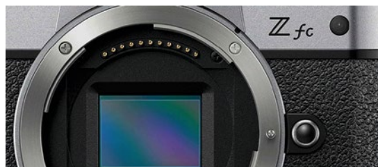
Bajonet objektivu a snímač bezzrcadlovky
