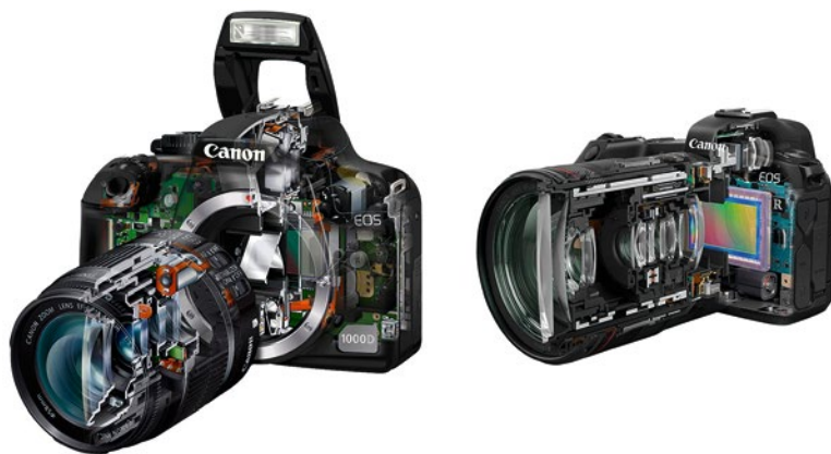
Schéma DSLR a bezzrcadlovky
