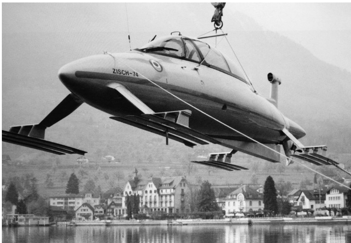
Člun „Zisch“ s podvodními nosnými plochami
