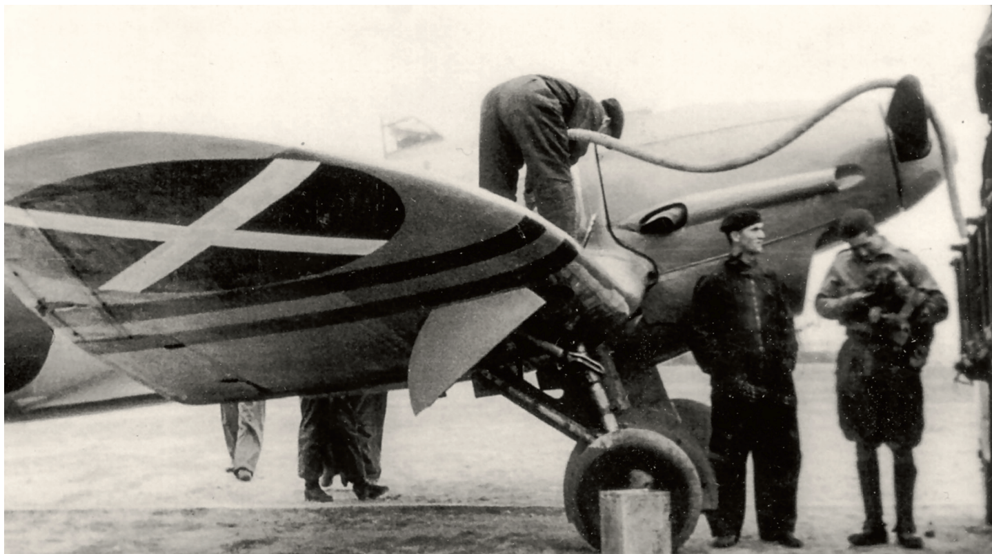
He 112 (5-1) vybavený již motorem Jumo 210B s dvoulistou vrtulí Schwarz v péči pozemního personálu
