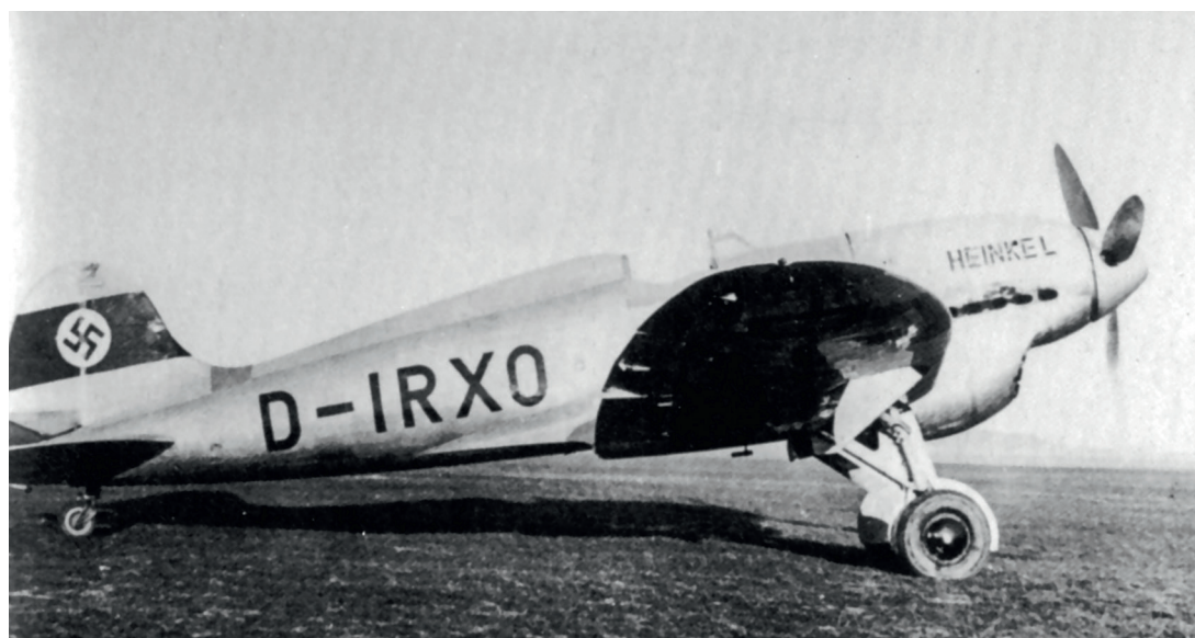
He 112 V8 (W.Nr. 1954, D-IRXO) náležel mezi stroje vyzbrojené kanonem Rheinmetall-Borsig MG C/30L pálicí dutou hřídelí vrtule. K pohonu ovšem sloužil novější motor Daimler Benz DB 600Aa
