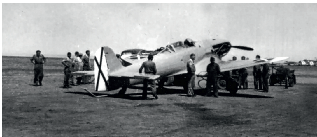
Personálem obklopený He 112 V9 ve Španělsku. Stroj má sejmuté krycí plechy motoru
