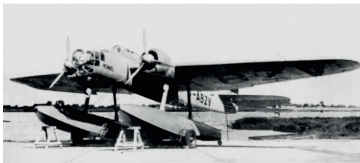
Heinkel He 115 V3 (W.Nr. 1555, D-ABVZ) během zkoušek ve Warnemünde. Obdržel již novou, moderněji tvarovanou příď (nacházelo se v ní pracoviště navigátora – velitele letounu)
