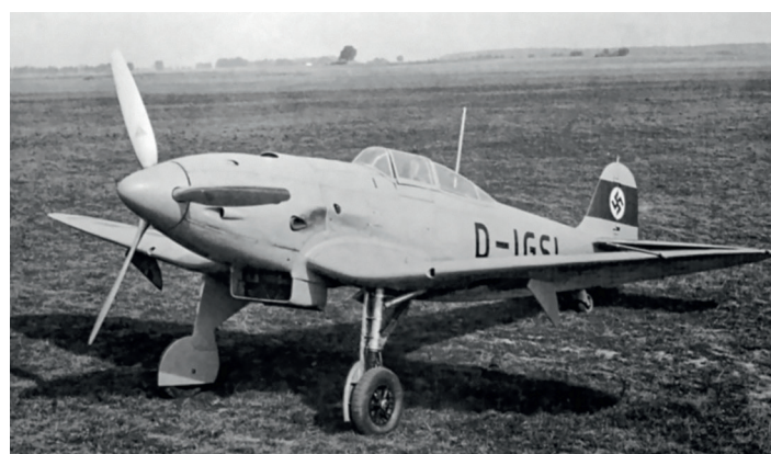
He 112 V9 (W.Nr. 1944, D-IGSI) ve finální podobě, vybavený třílistou kovovou vrtulí Junkers-Hamilton „Constant Speed“, radiostanicí a výzbrojí v podobě dvou křídelních kanonů MG FF ráže 20 mm a dvou trupových kulometů MG 17 ráže 7,92 mm
