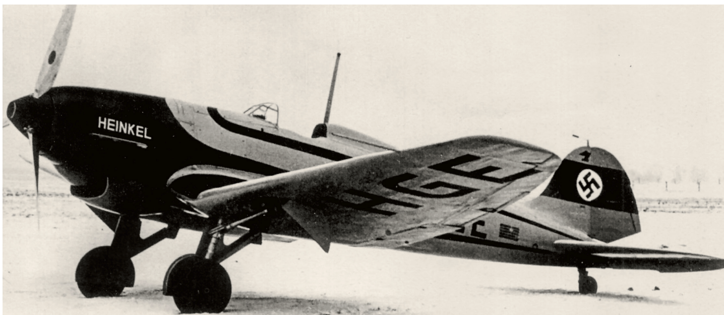
Finální podoba druhého prototypu He 112 V2 (W.Nr. 1291, D-IHGE) po opravách z únorové havárie, začátek roku 1936. Stroj je již vybaven upraveným křídlem, s rozpětím zkráceným „odříznutím“ jeho konců o celkových 1,1 m. Výzbroj tvoří trupový 20mm kanon MG C/30L, pálící osou třílísté vrtule Schwarz
