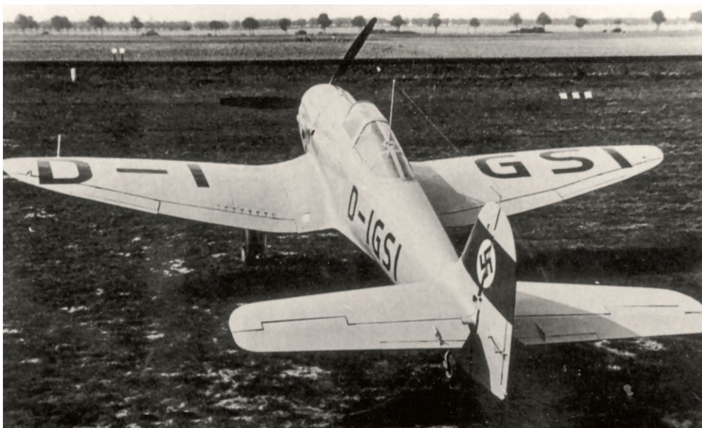
He 112 V9 (W.Nr. 1944, D-IGSI) poprvé vzlétl v červenci 1937. Zde je dobře vidět řešení nového křídla (již čtvrtého v pořadí) o rozpětí 9,1 m
