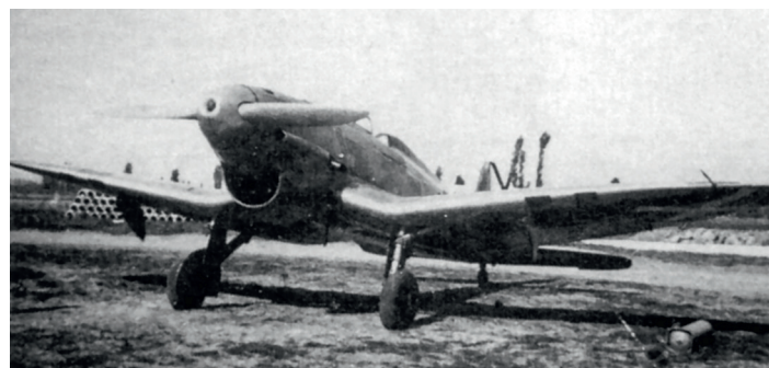
Prototyp He 112 (5-1) po úpravách, které prodělal ve Španělsku roku 1937. Původní pohonná jednotka byla vyměněna za Jumo 210B, roztáčející dvoulistou vrtuli Schwarz. Patrně je ústí kanonu Rheinmetall-Borsig MG C/30L, který pálił dutou hřídelí vrtule
