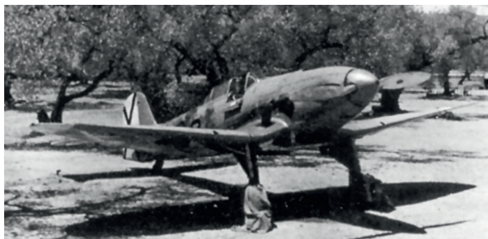
He 112 V9 na letišti La Cenia v létě 1938. Vidět je dvoulistá stavitelná vrtule Junkers-Hamilton a také ústí 20mm kanonů MG FF v náběžné hraně křídla
