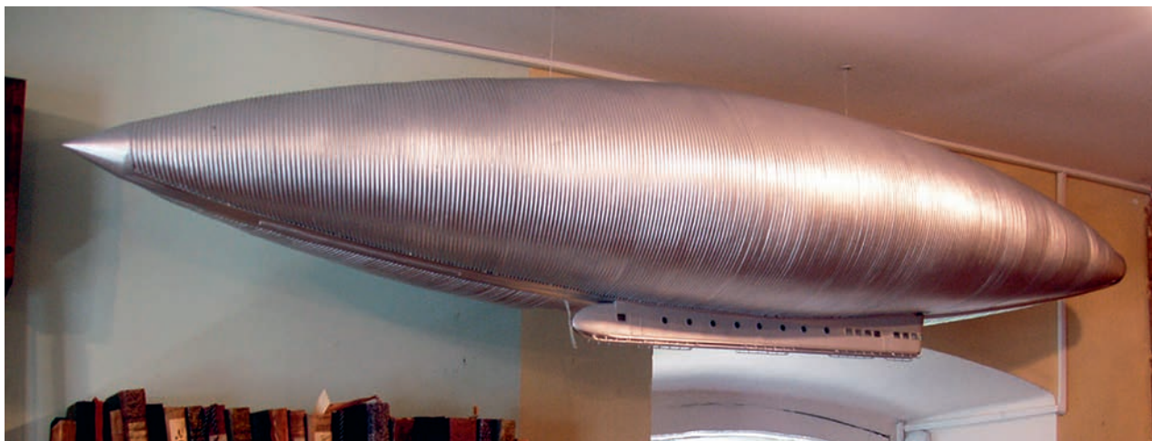
Celokovový aerostat (vzducholoď) – původní Ciolkovského konstrukce
