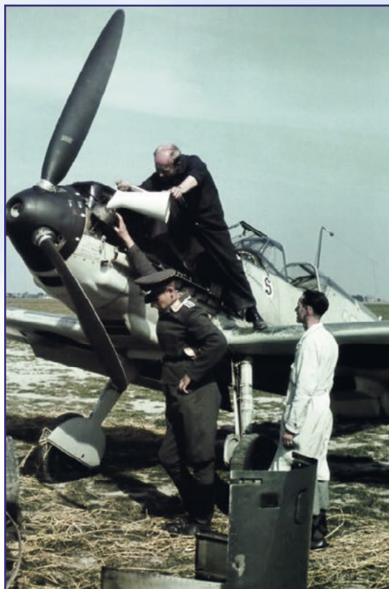
Pozemní personál pracující na motoru Daimler-Benz DB 601 umístěném v přídi Messerschmittu Bf 109 E
