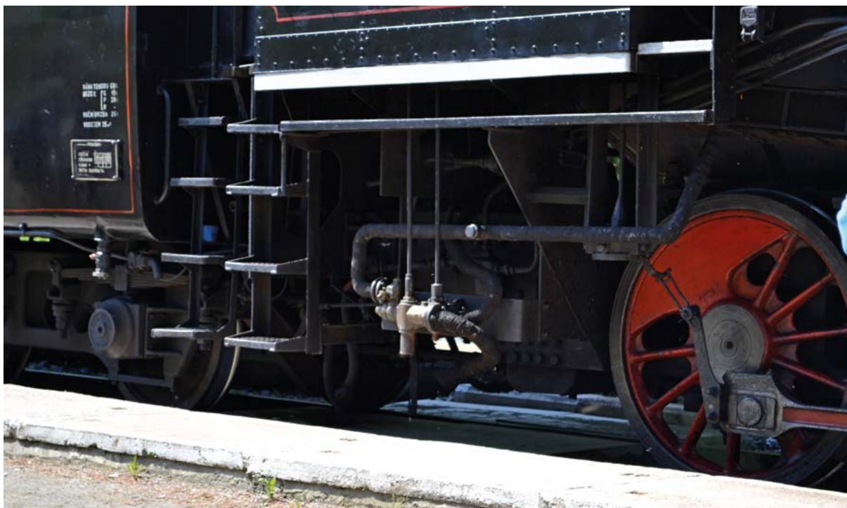
Na fotografii je nesací parní injektor. Většina parních lokomotiv ČSD měla dvě tyto armatury, po jedné na každé straně. Traťové lokomotivy měly vlevo nesací napáječ na výfukovou páru.
