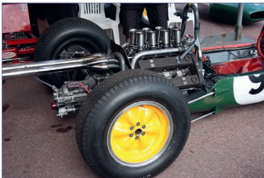
Motor Coventry-Climax v zádi Clarkova Lotusu Mk25
