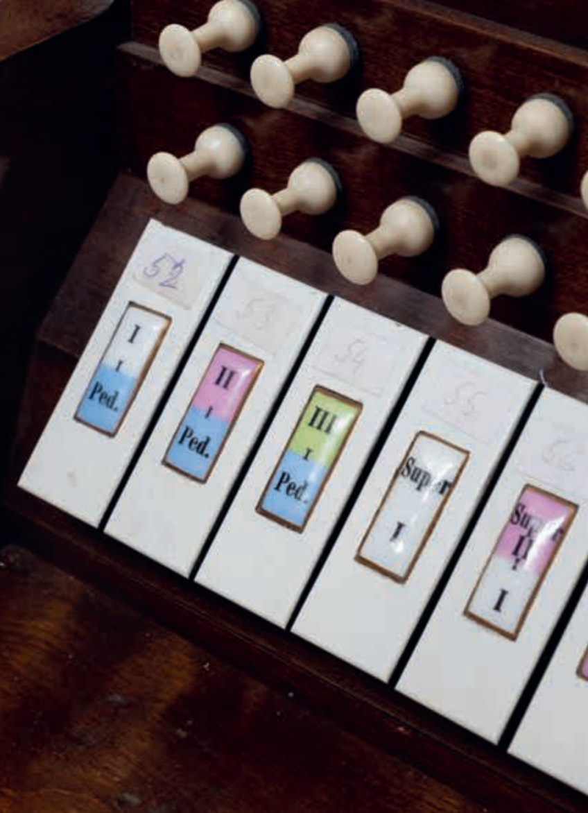
Rejstříkové sklopky, nad nimi dvě řady tahálek volné kombinace
