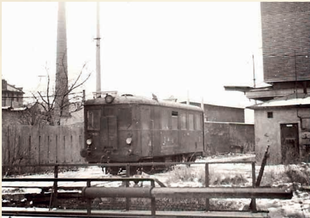
Vlečka Orion Modřany byla zvláštní tím, že na konci koleje souběžné s tratí cca 50 m jižně od dnešní Vrátnické ulice byla točna, která umožňovala přistavení vozů i na kolej kolmou k trati. Posun na vlečce zajišťoval motorový vůz M 131.1238, nasazený v roce 1978 za původní vůz M 222.006, který zde byl v provozu od roku 1953, sbírka Josef Bosáček.
