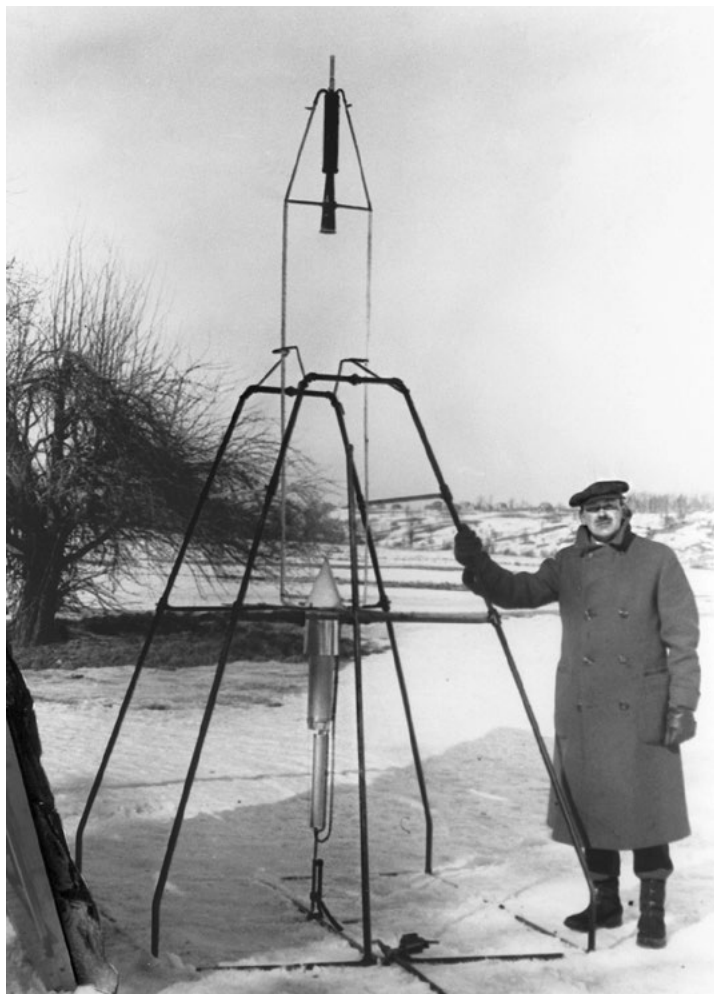
Robert Goddard s první kapalinovou raketou na světě, která skutečně odstartovala, Auburn, 16. 3. 1926. „Tak jako pokládáme 11. říjen 1492 za datum objevení Ameriky, tak 16. březen 1926 pokládáme za den zrodu kapalinových raket,“ napsal Jaroslav Golovanov
